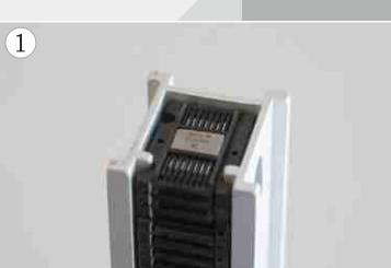
Пенал с микросхемами в СН на позиции загрузки. Подача СН с микросхемами в транспортную систему осуществляется автоматически.
