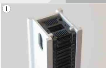
Пенал с корпусами СН без крышки и без микросхем на позиции загрузки. Подача корпусов СН в транспортную линию осуществляется автоматически.
