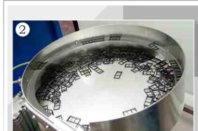
Крышки СН в вибробункере. Автоматическая подача крышки в транспортную линию.
