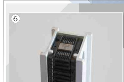
Пенал с микросхемами в СН на позиции выгрузки. Загрузка СН с микросхемами в пенал на позицию выгрузки осуществляется в автоматическом режиме.
